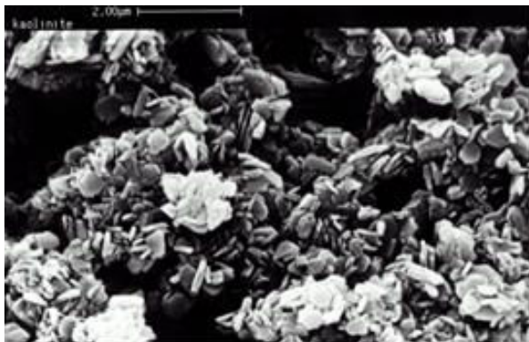
Figuur 1a en 1b: Gescande elektronenmicrograaf beelden van kristallen van kaolinetklei, oftewel porceleinaarde (maatstaf van figuur 1a is 2 microns)
