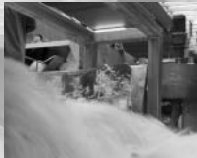
Deze komen op een lopende band waar ze met zout worden bestrooid (ongeveer 1,5%). Het koolschaafsel komt in een grote bak, die in een stenen put wordt gelegd.
