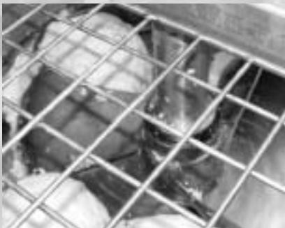
Daarna komt de kool in een grote ronddraaiende schaar. Deze schaarft de kool in millimeter dunne plakjes.
