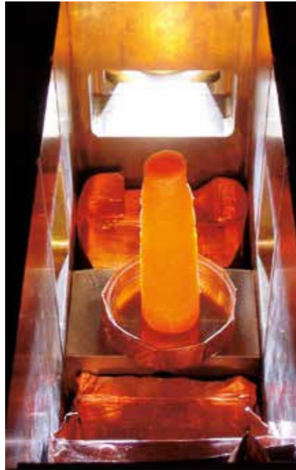
Een wortel in een apparaat om te meten hoe goed hij licht vasthoudt; de methode van Delayed Luminescence
