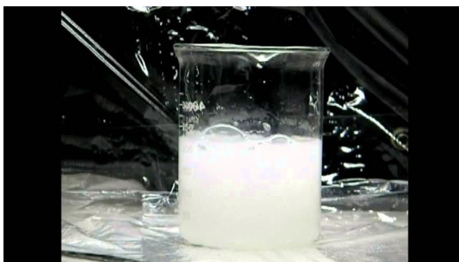
Na een minuut zien we het witte calciumhydroxide ontstaan De opgeloste calciumhydroxide noemen we kalkloog
